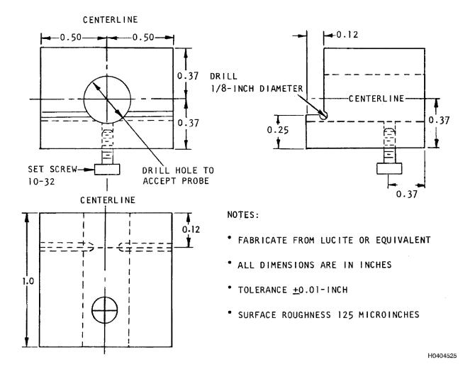
Figure 4-53. Edge Probe Guide
